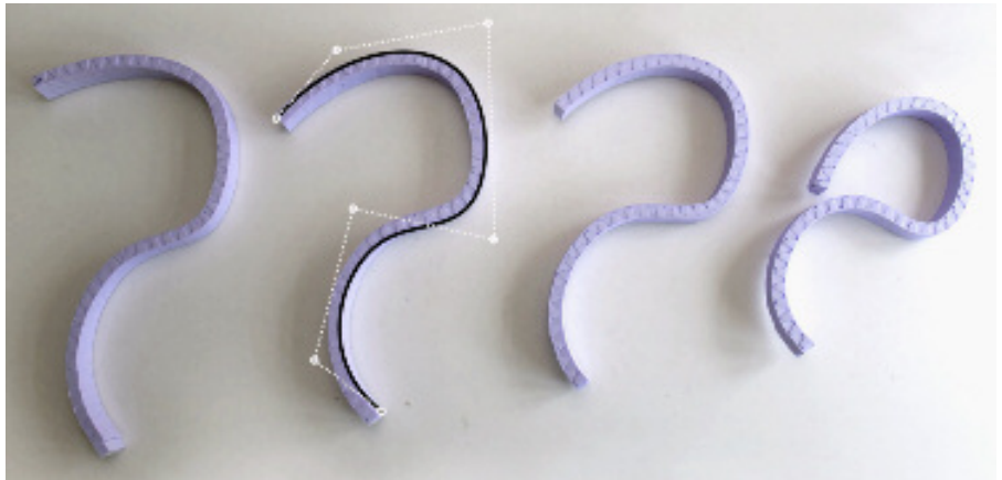
Vier XPS Prüfstücke mit einem zunehmenden «Rückfederungs-Faktor», der die Krümmung in den abgewickelten Platten übersteigert. Die schwarze Kurve auf dem zweiten Prüfstück ist die ursprüngliche Ausgangskurve. ETH RAPLAB, Zürich, August 2010.
