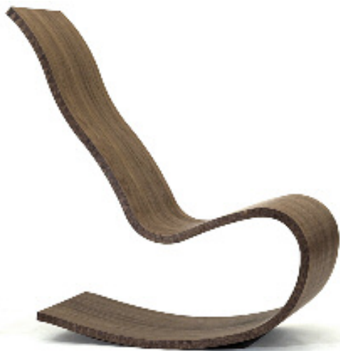
Der «Ziprocker», entwickelt mit R. Aimer, K. von Felde, O. Illner, S. Rehders, T. Schütt und H. Wolf, ist ein auskragender Schaukelstuhl mit einer Gesamtmaterialstärke von 30 mm, zusammengesetzt aus einer Fichten-Mittellage mit Nussbaumfurnier-Deckschichten. Die Form wurde von einem Autositz abgeleitet. Fachschule für Holztechnik Hamburg, Januar 2009. Bild: Kyeni Mbiti
