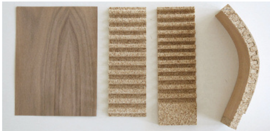
«Recoflex» ist ein Verbundwerkstoff aus Holz-, Kork- und Latexpartikeln. Er ist ziemlich elastisch, wird aber steif, sobald Furniere aufgeleimt sind. ETH RAPLAB, Zürich, Juli 2010.
