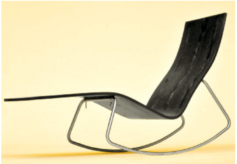
Die «ZipLiege» besteht aus einer 18 mm Recoflex-Mittellage mit aufgeleimten Eschenfurnieren. Die Form wurde von Körpermassen abgeleitet. Sie wurde 5-achsig von der Schreinerei Schnidrig in Visp gesägt und an der BFH-AHB in Biel vakuumverleimt. Designers' Saturday 2010, Langenthal, November 2010. Bild: Kyeni Mbiti
